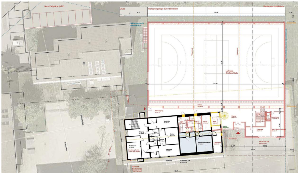
Mit schwarzen Mauern zu erkennen ist das Erdgeschoss der alten Furren Turnhalle. Diese Halle bleibt bestehen. Rot eingezeichnet ist der Grundriss der neuen Dreifachhalle, welche westwärts direkt angrenzend realisiert werden soll. Plan: zvg
